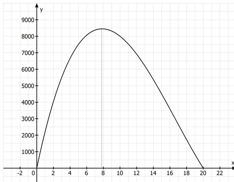
Dem Graphen der Funktion entnehmen wir, dass bei einer Höhe von etwa 7,8 cm das Volumen der Schachtel maximal ist.
